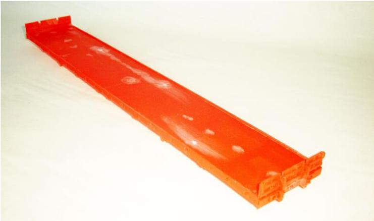
Nachdem auf die Unterseite 2 Profileleisten geklebt werden, wird das Gehäuse mit einem Kunststoff primer besprüht.
