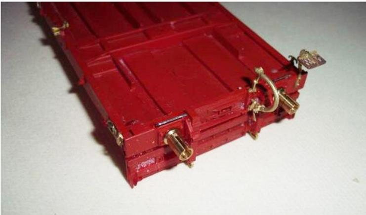
Über die Splinte wird die Hülse geschoben, als Abstandstück, um die Entlüftung Gestänge zu umfassen.
