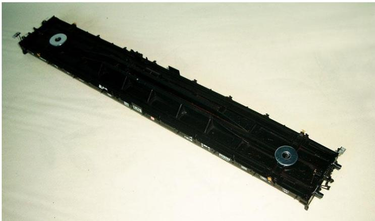
Nachdem die Puffer und Kupplungen montiert sind, werden die Drehgestelle den Wagen angeschraubt.
