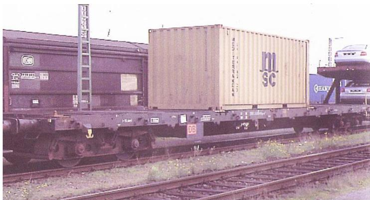
*Auf Grund einer Rs 685 Rungenwagen, (die MOSPAT schon vorher in Bausatz hat aufgelegt), wird dieser Modell Gattung Rs 672 umgebaut mit Zurüstung einer Container Rahmen, andere Drehgestelle, Abbau der Rungen und geänderte Beschriftung.*
