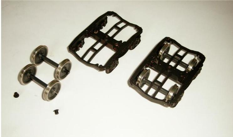
Das Unterrahmen bekommt 2 Unterlegscheiben für die Führung der Drehgestelle.
